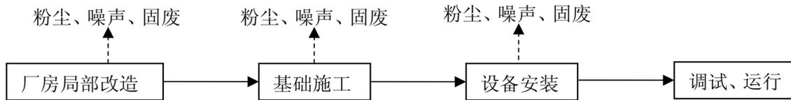
图 5-1 项目施工期产污工艺流程图
